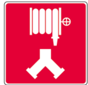
Raccords-pompiers pour les cabinets d'incendie
