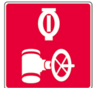
Valve du réseau de gicleurs
