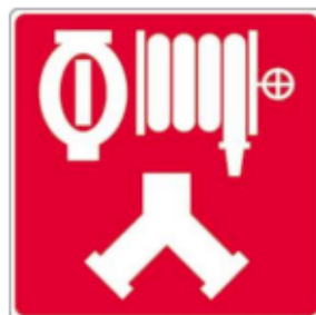
Raccords-pompiers pour le réseau de gicleurs et les cabinets d'incendie
