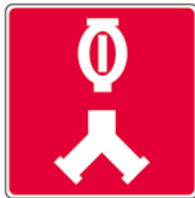
Raccords-pompiers pour le réseau de gicleurs
